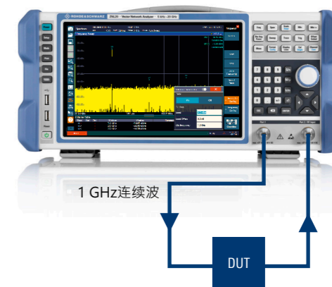
使用0 dBm (1 GHz) CW输入信号的共模变压器输出信号频率扫描。
