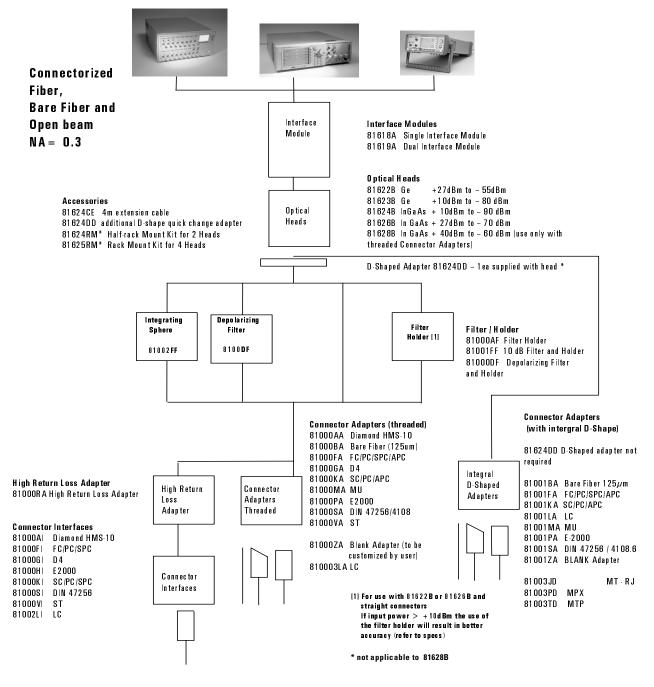
Figure 7 Optical Head Accesories (5 & 3 mm Sensors)
