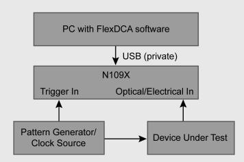
Figure 2. N1090X System Setup
